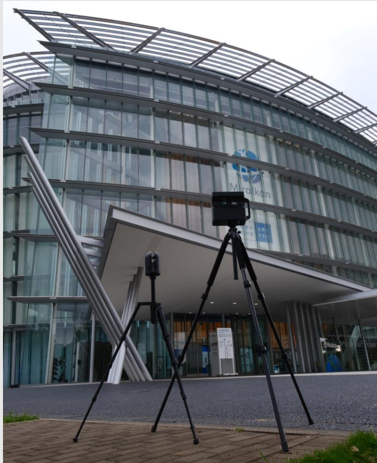
3Dデータの撮影機材。左が Leica BLK360、右が Matterport
